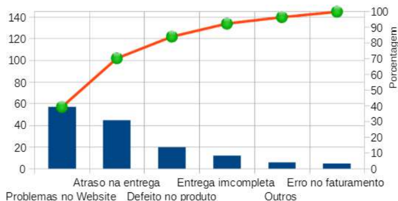
Figura 12 - Exemplo de aplicação do diagrama de pareto (gráfico)
