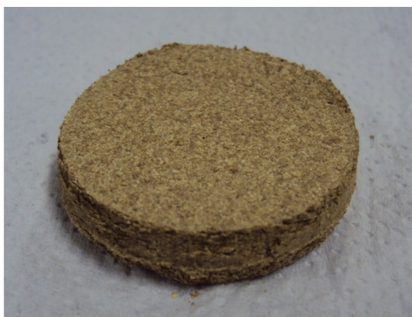
FIGURA 5: Pastilha da amostra A feita com a madeira moída (3,5 cm de diâmetro).
