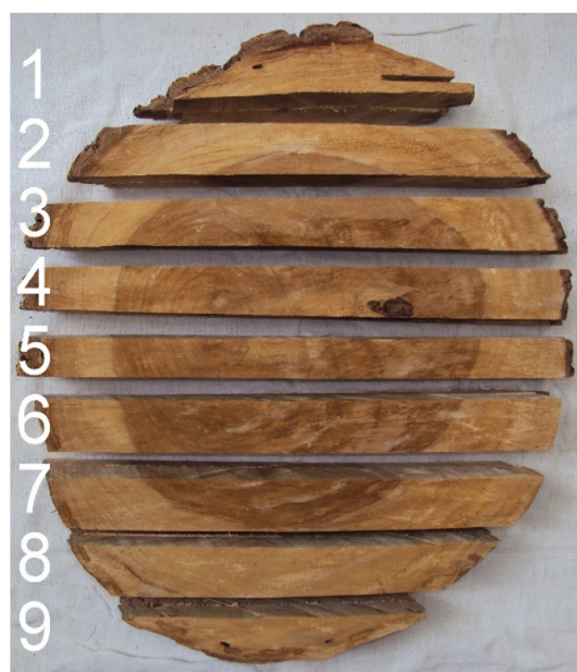
FIGURA 3: Demonstração do corte do disco da amostra A cortado em nove fatias. FIGURE 3: Demonstration of the cutting disc of the sample A cut into nine slices.
