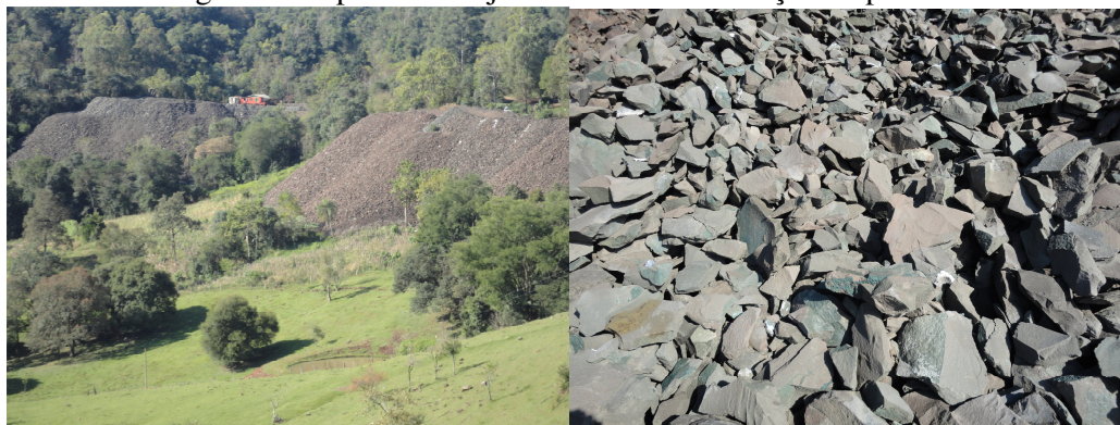
Figura 2- Depósito de rejeitos sólidos da extração de pedra ametista.
