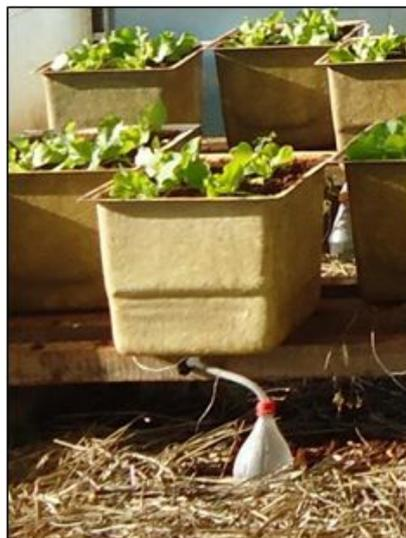
**Figura 2. Lisímetros com dreno e reservatório instalado. Fonte: Própria Autoria**
