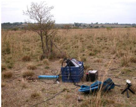
La figura muestra, el equipo de adquisición y almacenamiento de datos, batería de alimentación y GPS
