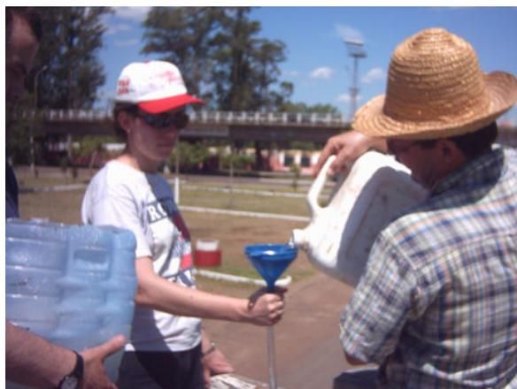
Una vez determinado el volumen, se prepara la solución saturada en cloruro de sodio y se vierte en la manguera que se encuentra dentro de la perforación. Luego se retira la manguera asegurando una distribución uniforme a lo largo de la columna de agua de la solución de agua y cloruro de sodio. Posteriormente, se
