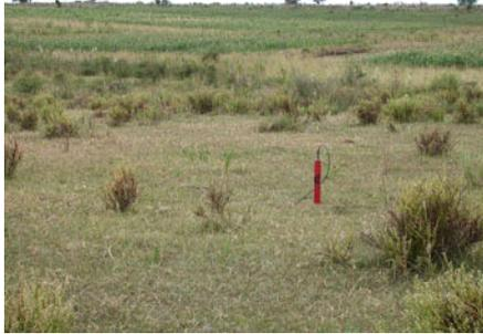
Se puede apreciar la bobina con orientada verticalmente
