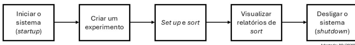
**Figura 2 – Fluxo operacional do citômetro de fluxo**
