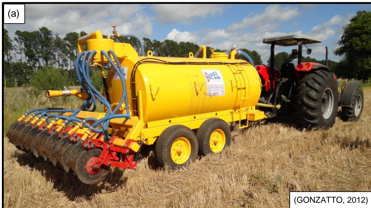
Figura 4. Equipamento desenvolvido pela empresa MEPEL Máquinas e Equipamentos (a) para a distribuição de adubos orgânicos líquidos por meio da injeção (DAOL-i®) subsuperficial desses dejetos no solo em sistema de plantio direto (b).
