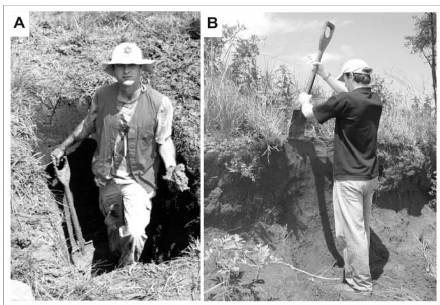
Figura 3. Exemplo da preparação do perfil para coleta do monolito em trincheira (A) e em cortes de estrada (B).
