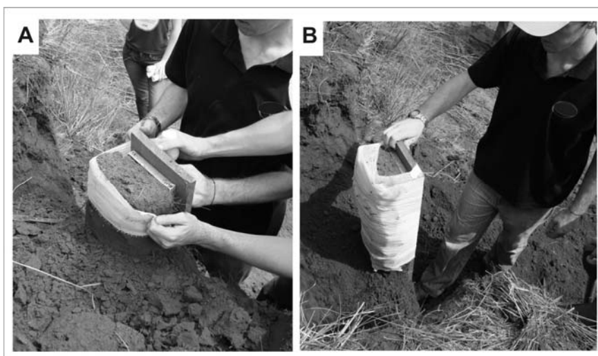
Figura 8. Detalhe do uso da atadura para enrolar o monolito (A); Detalhe da escavação em torno do monolito (B).
