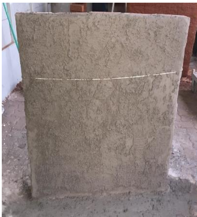
Figura 8 - Parede finalizada com vidro moído como substituição do pó de mica, Conjunto II da Universidade Franciscana, Santa Maria – RS. Fonte: Acervo da acadêmica Taissa Kulmann Werlang.
