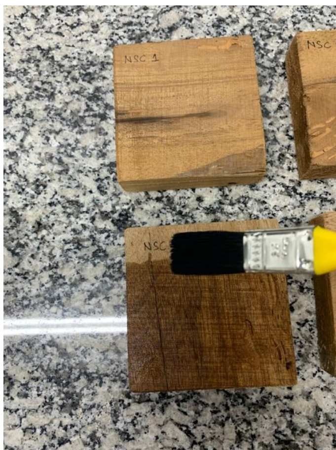
Figura 2 - Aplicação superficial de querosene nas amostras. Fonte: Os autores.
