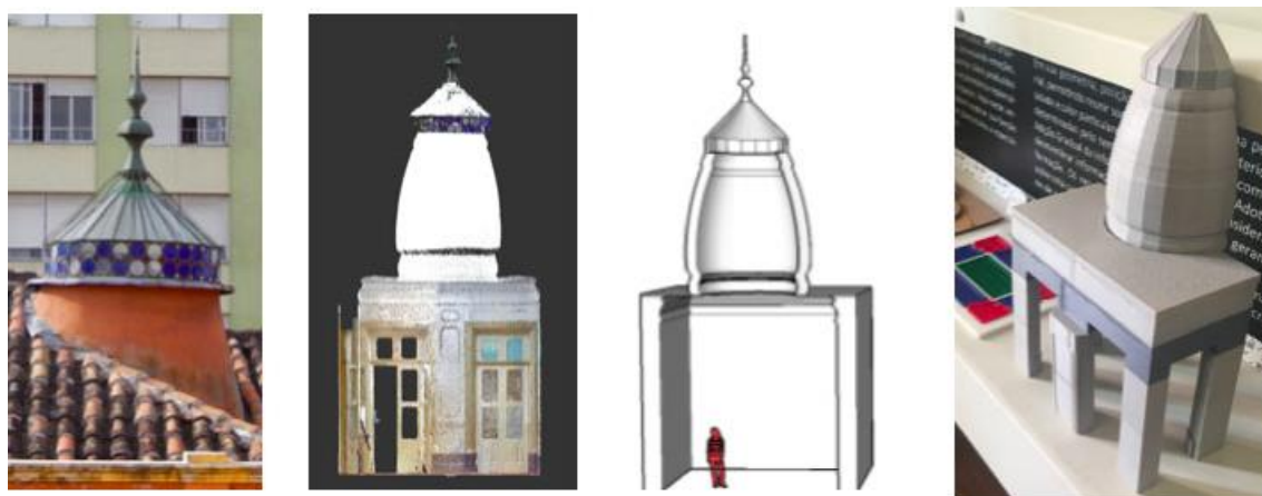
Figura 5 - Ilustração das etapas do processo de geração de um modelo tátil por impressão 3D. Na sequência, da esquerda para direita: foto do objeto; nuvem de pontos; modelagem 3D; objeto tátil. Fonte: Arquivo Gegradi.
