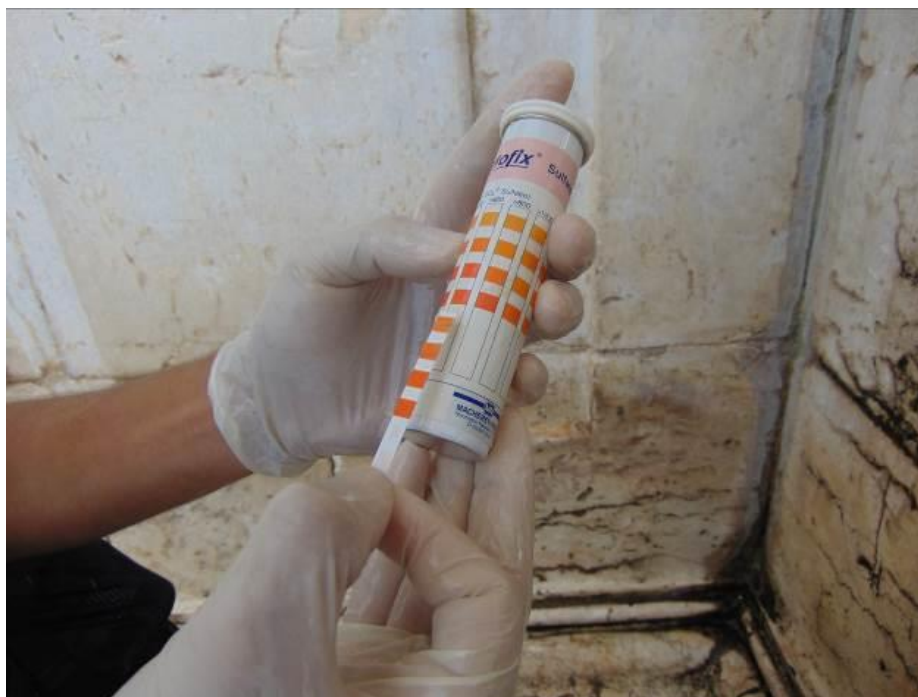
Figura 3 - Testagem da contaminação por sais solúveis in loco . Fonte: acervo dos autores.
