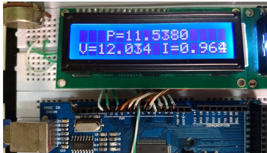
Figura 4.26 – Medidas realizadas pelo circuito do multimetido (Tensão (V) em Volts, corrente (I) em Amperes e potência (P) em Watts) para uma carga resistiva.
