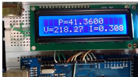
Figura 4.28 – Medidas realizadas pelo circuito do multimetador (Tensão (V) em Volts, corrente (I) em Amperes e potência (P) em Watts) para uma carga indutiva.
