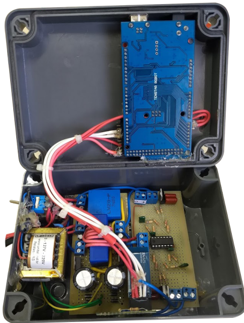
Figura 4.32 – Visão interna do protótipo do multimetido desenvolvido.
