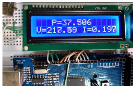
Figura 4.30 – Medidas realizadas pelo circuito do multimedidor (Tensão (V) em Volts, corrente (I) em Amperes e potência (P) em Watts) para uma carga não linear.
