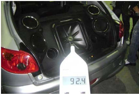
Figura 4.34: Medição do NPS emitido pelo sistema de som de um automóvel durante exposição no evento do Dia do Trabalhador.
