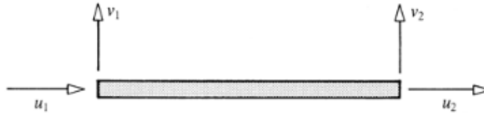
Figura 3.1 – Esquema do elemento de barra com os dois graus de liberdade associados as suas duas pontas.
