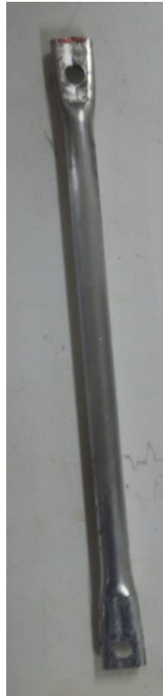
Figura 4.7 – Elemento de 200mm feito para a montagem da treliça.
