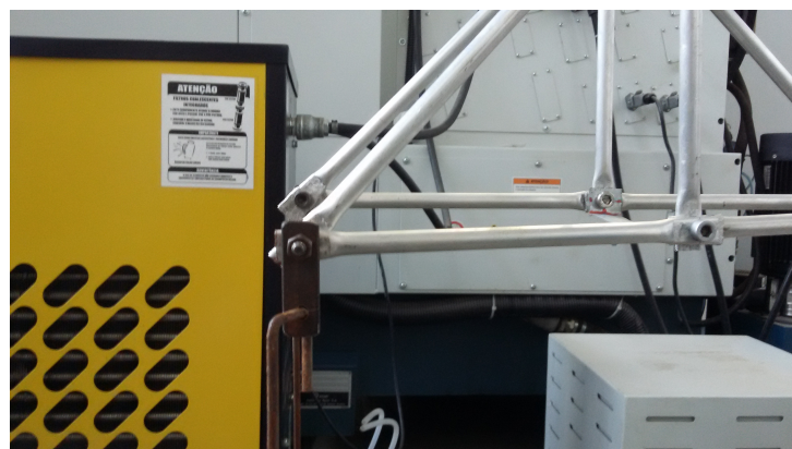
Figura 5.5 – Fotografia tirada durante um dos ensaios em que a treliça é submetida a carga máxima medida. Neste caso um desnível é presente entre os lados direito e esquerdo da estrutura.
