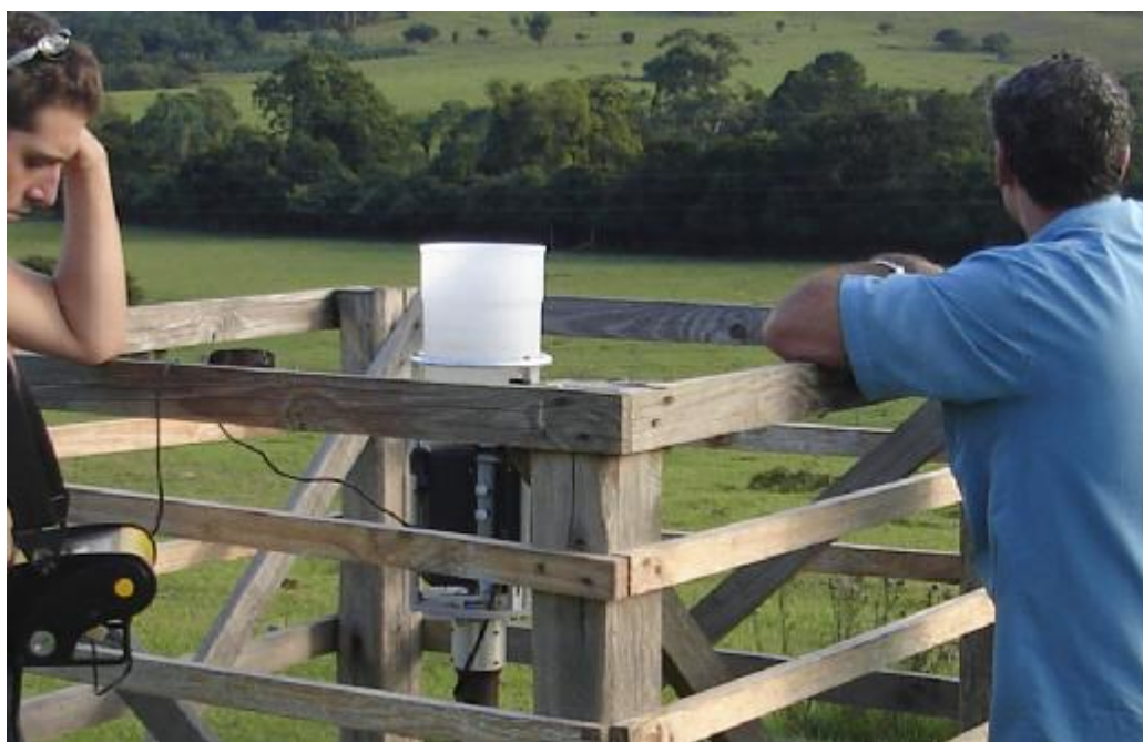
Figura 4.11 - Estação pluviométrica São Martinho da Serra ( pluviômetro com data-logger, modelo A-OTT Pluvio)
