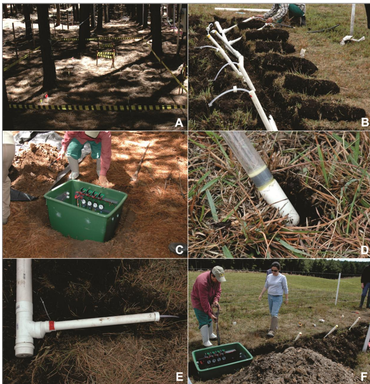
Figura 4.2 - Aspectos da instalação do experimento em Cambará do Sul, RS, Brasil. Área após a instalação dos lisímetros (A); instalação da tubulação na área de campo (B); instalação da base de coleta da solução do solo no interior do Pinus taeda L. (C); Ponteira de cerâmica de um lisímetro (D); Detalhe da tubulação usada para proteção dos capilares (E) e instalação da base de coleta da solução do solo na área de campo (F). Fonte: elaborado pelo autor.
