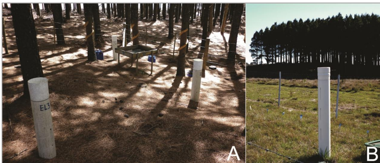
Figura 3.1 - Aspecto dos coletores da precipitação interna, instalados no povoamento de Pinus taeda L. (A); coletor da precipitação pluviométrica na área de campo adjacente (B). Fonte: elaborado pelo autor.
