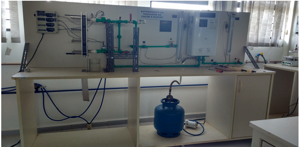
Figura 8. Módulo didático de trocadores de calor, vista frontal.
