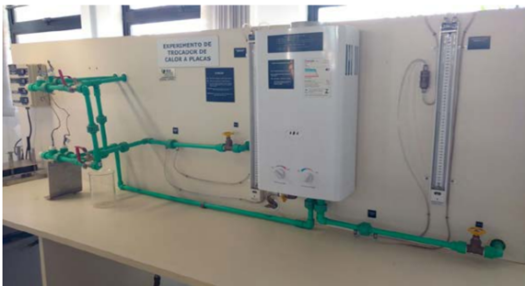
Figura 9. Módulo didático de trocadores de calor, parter a cima da bancada.
