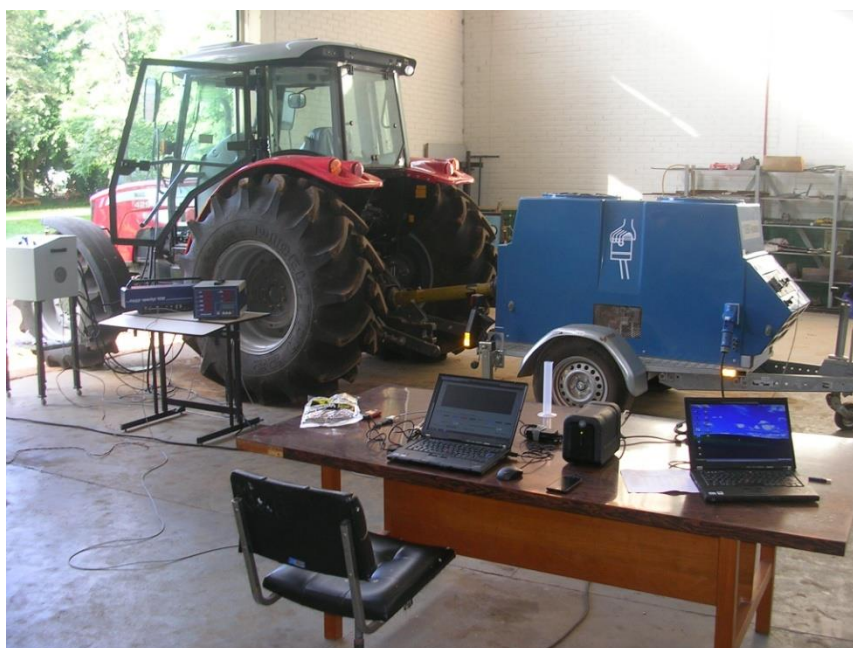
Figura 9 – Avaliação do desempenho e da emissão de gases poluentes de um motor agrícola, com o uso de diferentes combustíveis.
