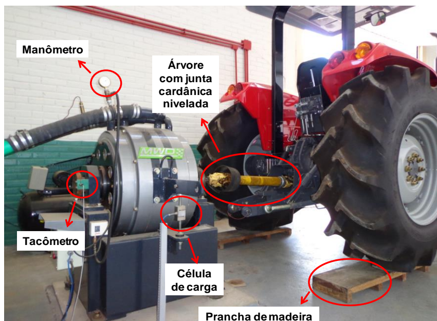
Figura 6 – Dinamômetro de correntes parasitas ou correntes de Foucault (elétrico) marca MWD, modelo NL 480 e trator agrícola, devidamente posicionado e acoplado ao dinamômetro, por meio de uma árvore com junta cardânica.
