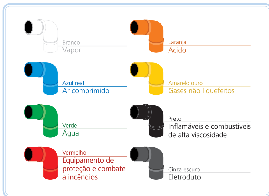
Figura 5.2: Identificação de cores para tubulações
