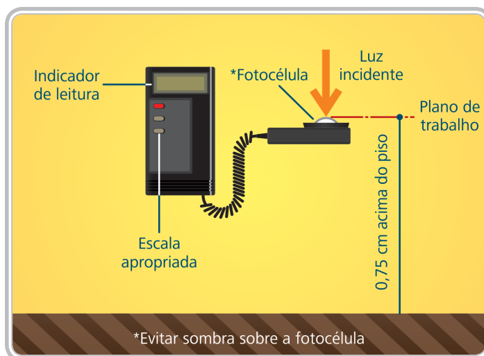
Figura 10.13: Medição da iluminância com o luxímetro
