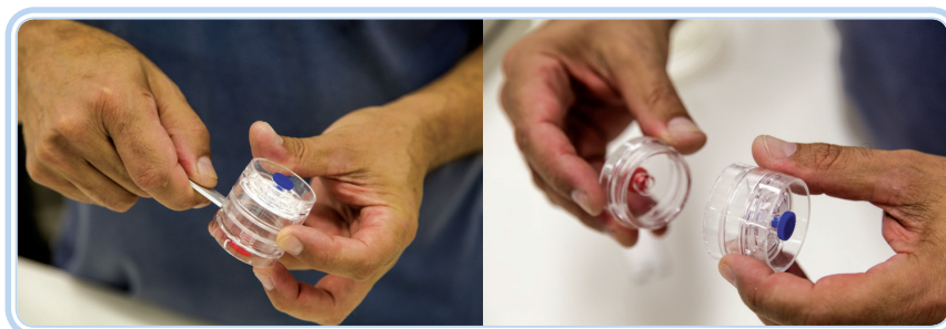
Figura 4.9: Retirada da parte inferior (lisa) do cassete de três secções
