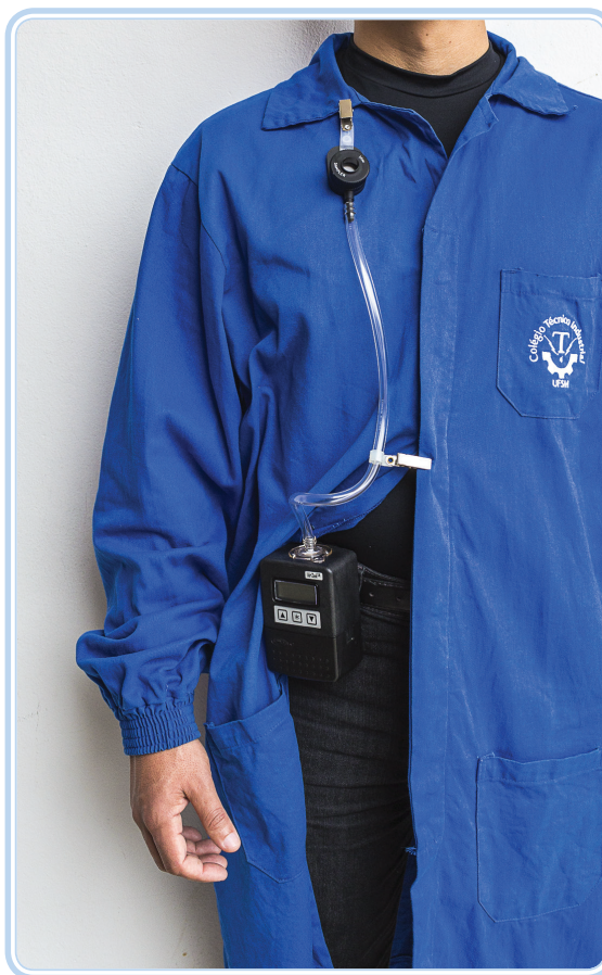
Figura 4.21: Amostrador IOM pronto para a amostragem
