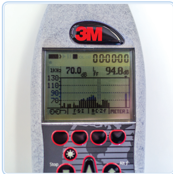
Figura 1.12: Avaliando o ruído em bandas de terço de oitavas (1/3)
