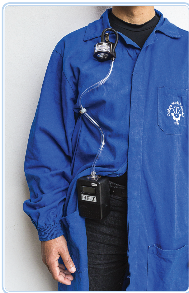
Figura 4.7: Conjunto pronto para a amostragem de poeira total
