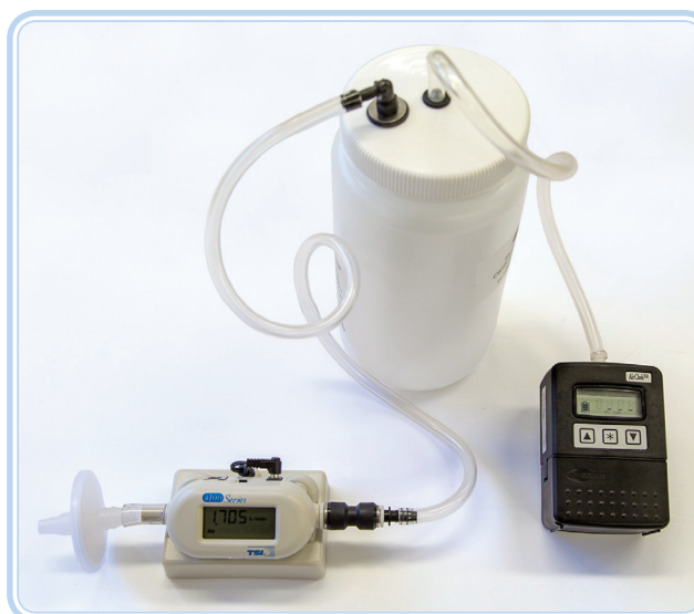
Figura 4.16: Esquematização de calibração na avaliação de poeira respirável com ciclone de nylon
