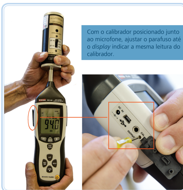
Figura 1.6: Calibração do sonômetro não integrador
