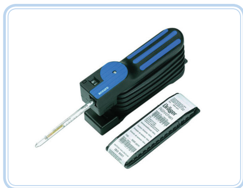
Figura 5.10: Bombas de fole para tubos colorimétricos
