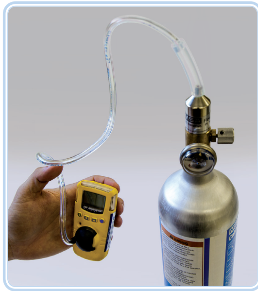
Figura 5.30: Calibração de equipamento monogás
