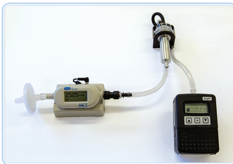
Figura 4.12: Esquematização de calibração na avaliação de poeira respirável com ciclone de alumínio
