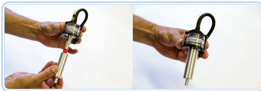
Figura 4.11: Montagem da câmara de calibração do ciclone
