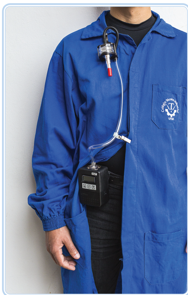
Figura 4.13: Conjunto pronto para a amostragem de poeira respirável utilizando ciclone de alumínio
