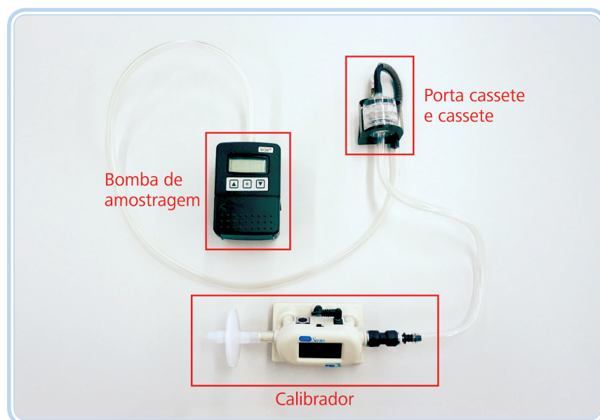
Figura 4.3: Calibração amostragem de poeira total
