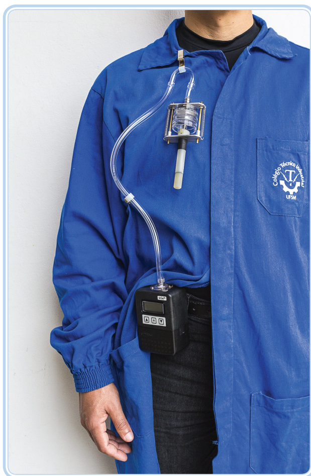
Figura 4.17: Conjunto pronto para a amostragem de poeira respirável utilizando ciclone de nylon
