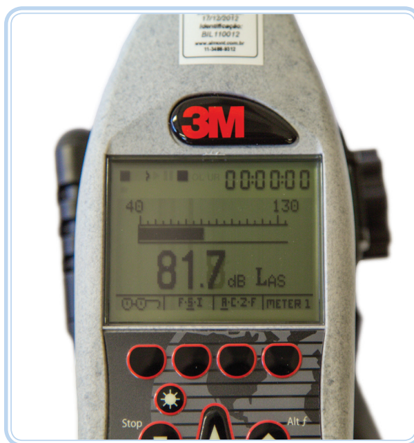
Figura 1.8: Avaliação do ruído com sonômetro integrador
