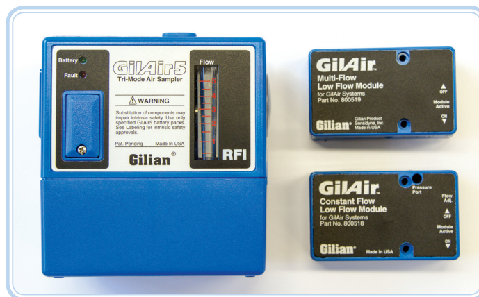
Figura 5.14: Bomba de alto fluxo com adaptadores externos para baixo fluxo (baixo fluxo de ar com modo de controle de fluxo constante para aplicações com um único tubo absorvente e o modo multifluxo (controle de pressão constante) que permite várias amostras sendo tomadas simultaneamente (tubos múltiplos))
