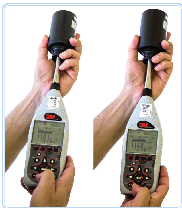
Figura 1.7: Calibração do sonômetro integrador. Observe que o ajuste é feito eletronicamente sobre as teclas do equipamento
