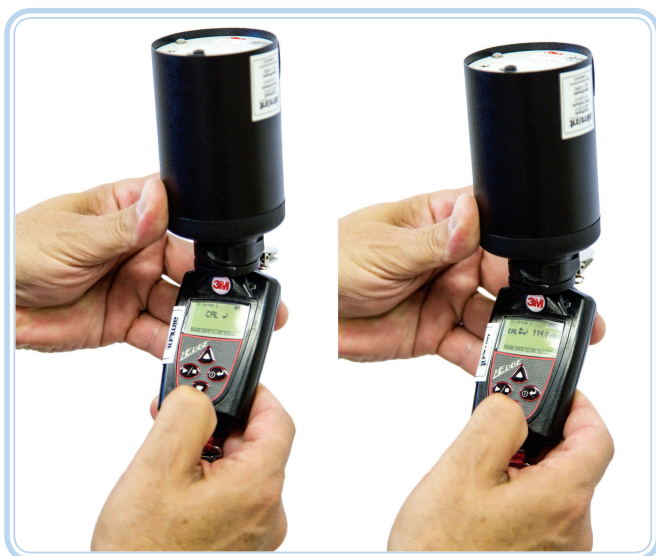
Figura 2.2: Calibração do dosímetro de ruído
