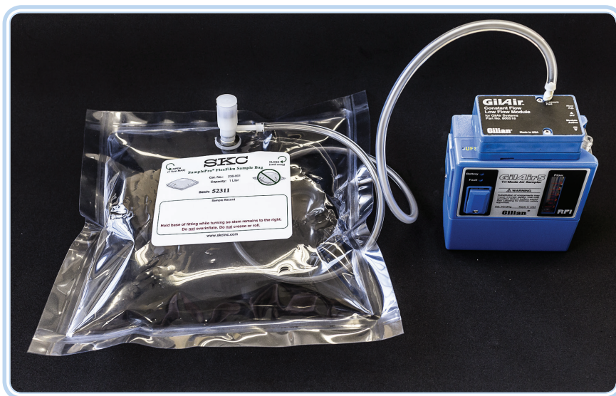
Figura 5.26: Coleta de ar total com bomba de baixo fluxo para bags de amostragem Fonte: CTISM
