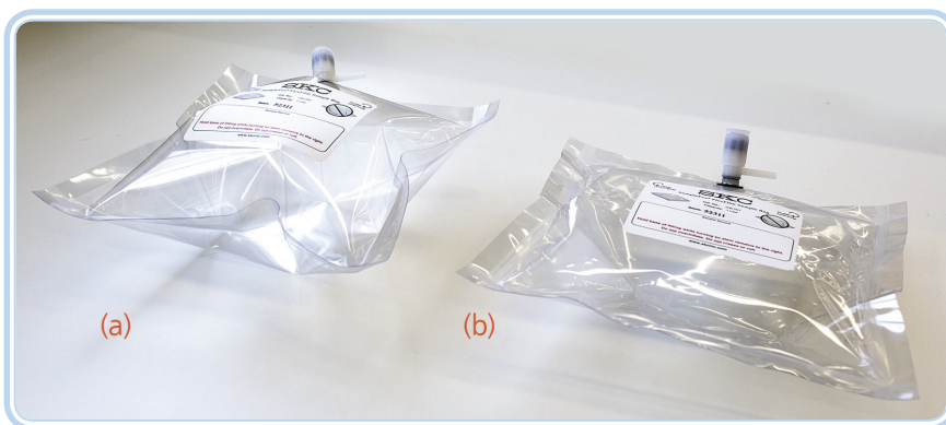
Figura 5.27: Bags de amostragem com enchimento incorreto (a) e com enchimento correto (b) Fonte: CTISM
