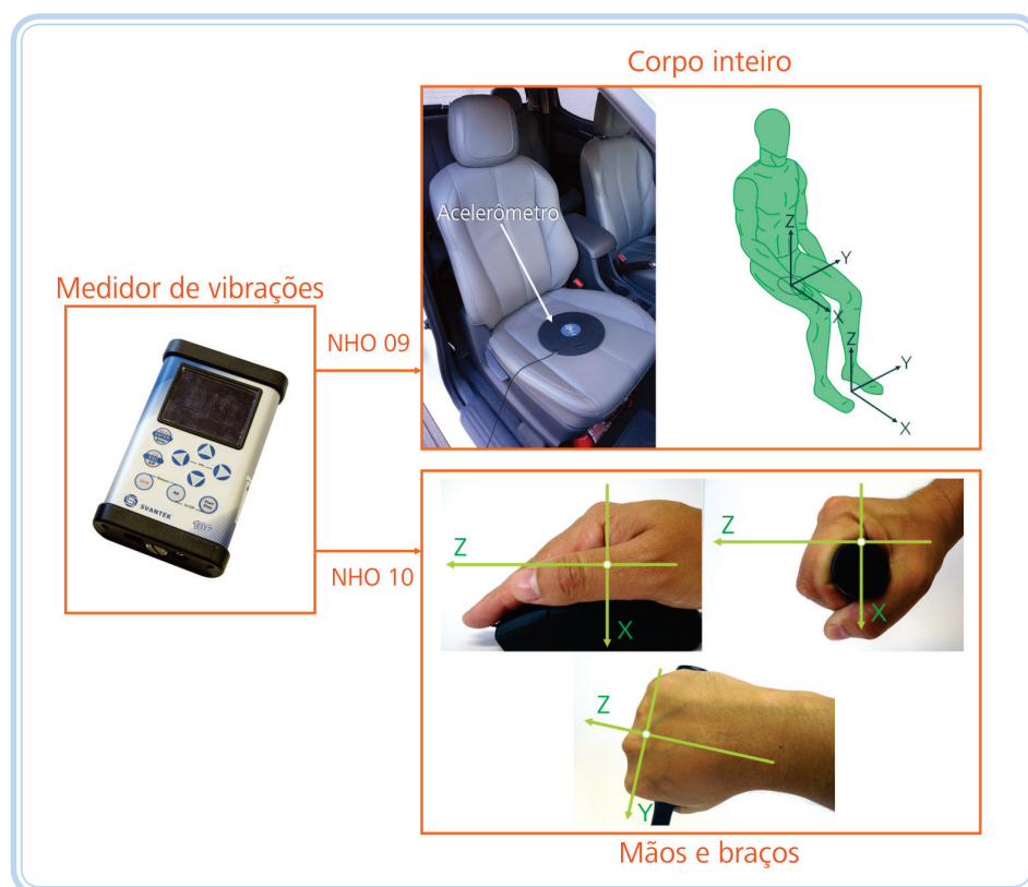
Figura 7.6: Acelerômetro e posição dos sensores
