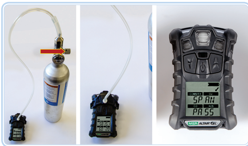
Figura 6.6: Procedimento da calibração de Span
