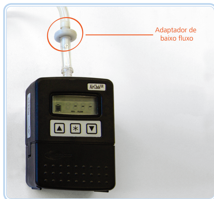
Figura 5.15: Bomba de alto fluxo com adaptador externo para baixo fluxo
