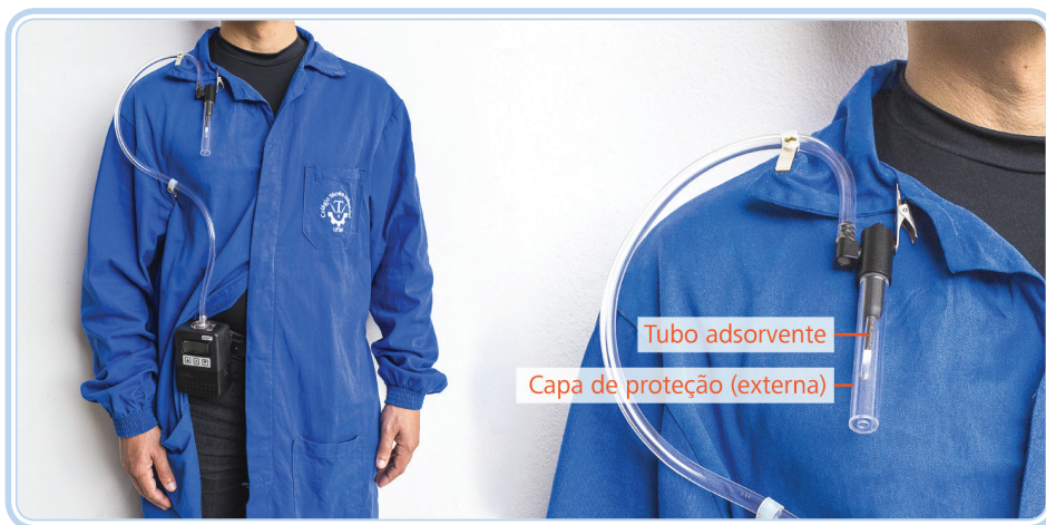
Figura 5.25: Amostragem com tubo adsorvente (modelo 2)
