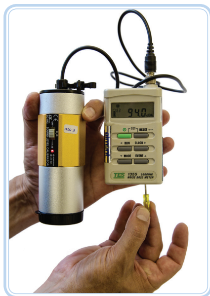
Figura 2.3: Calibração para outro modelo de dosímetro de ruído
