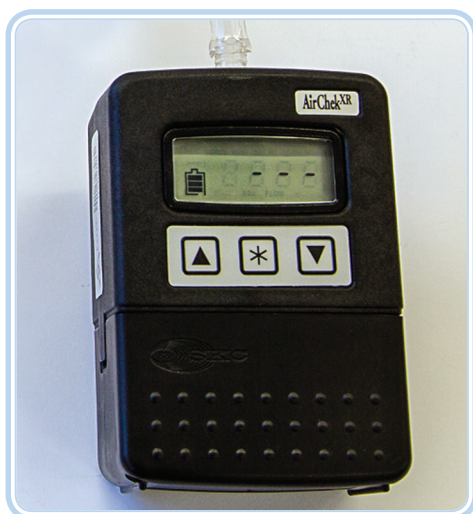
Figura 4.5: Ajuste eletrônico da vazão
