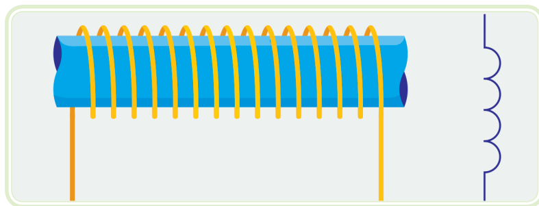
Figura 3.7: Esquema de um indutor à esquerda e seu símbolo à direita
