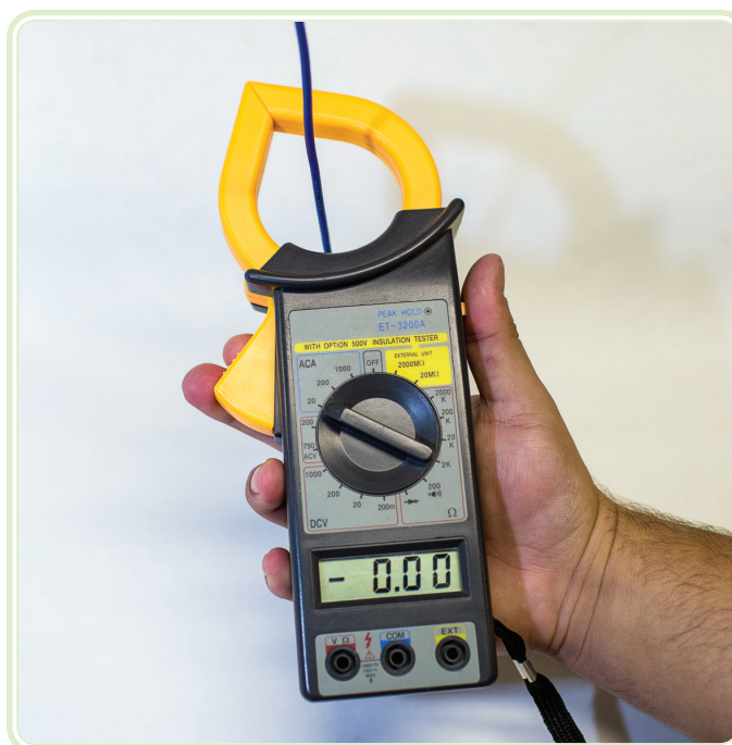
Figura 5.4: Medição de corrente com um amperímetro com garra
