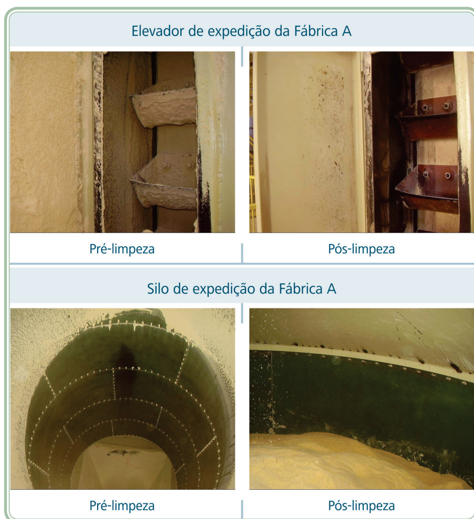
Figura 9.13: Pontos críticos de controle (elevador de expedição e silo de expedição). Imagens antes e após limpeza de alguns equipamentos em duas fábricas de rações
