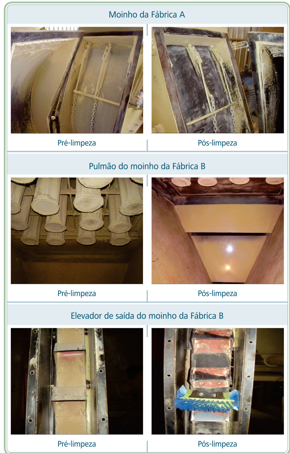
Figura 9.9: Pontos críticos de controle (moinhos, pulmão do moinho e elevador do moinho). Imagens antes e após limpeza de alguns equipamentos em duas fábricas de rações
