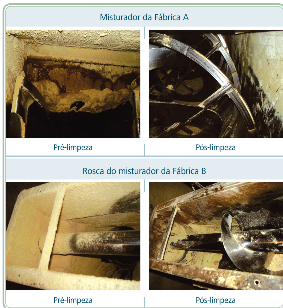
Figura 9.12: Pontos críticos de controle (misturador e rosca do misturador). Imagens antes e após limpeza de alguns equipamentos em duas fábricas de rações
